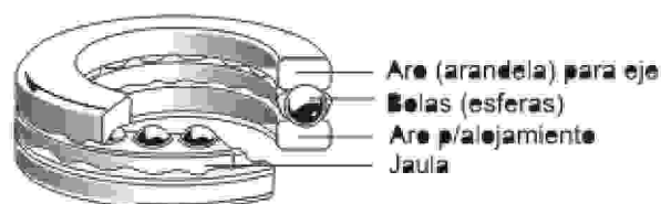
Rodamiento axial de bolas
