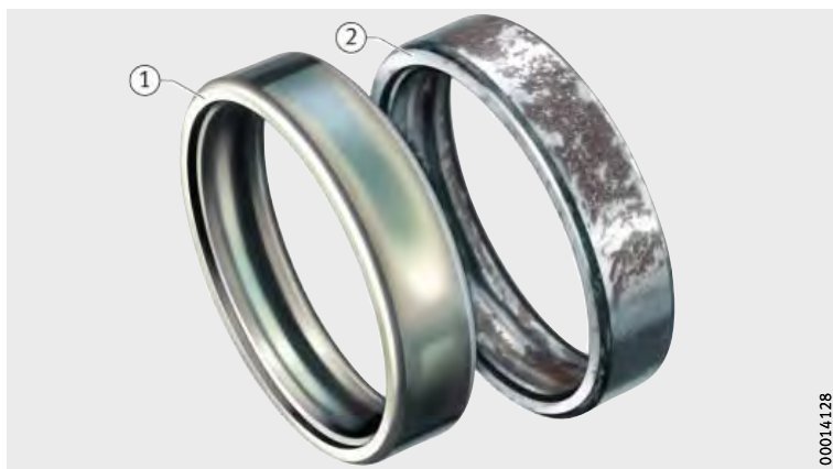
Figura 11 Anillos de un rodamiento después del ensayo de niebla salina
